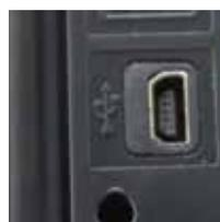
Dettaglio della connessione USB
